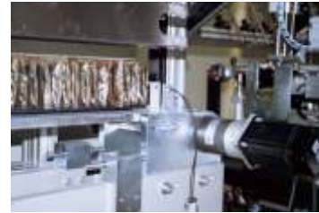
Fig. 4. Aplicație de inspecție a etichetării cu sistem OMRON
